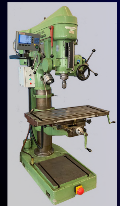
Ständerbohrmaschine mit 3-Achsen Digitalanzeige
